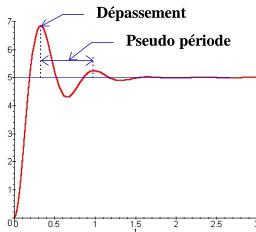
Le dépassement est donc  $d = \frac{D}{V_F - V_I} = \frac{KE_0(1 + e^{\frac{-\pi z}{\sqrt{1-z^2}}}) - KE_0}{KE_0 - 0} \quad d = e^{\frac{-\pi z}{\sqrt{1-z^2}}}$
