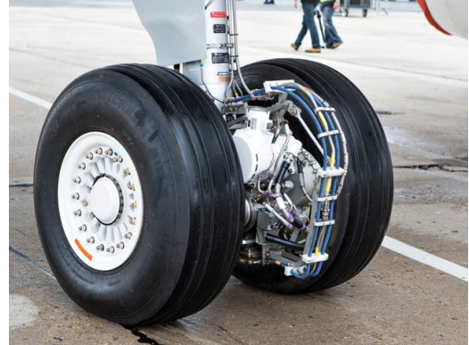
FIGURE 9.12 – EGTS monté sur un train d'atterrissage principal
