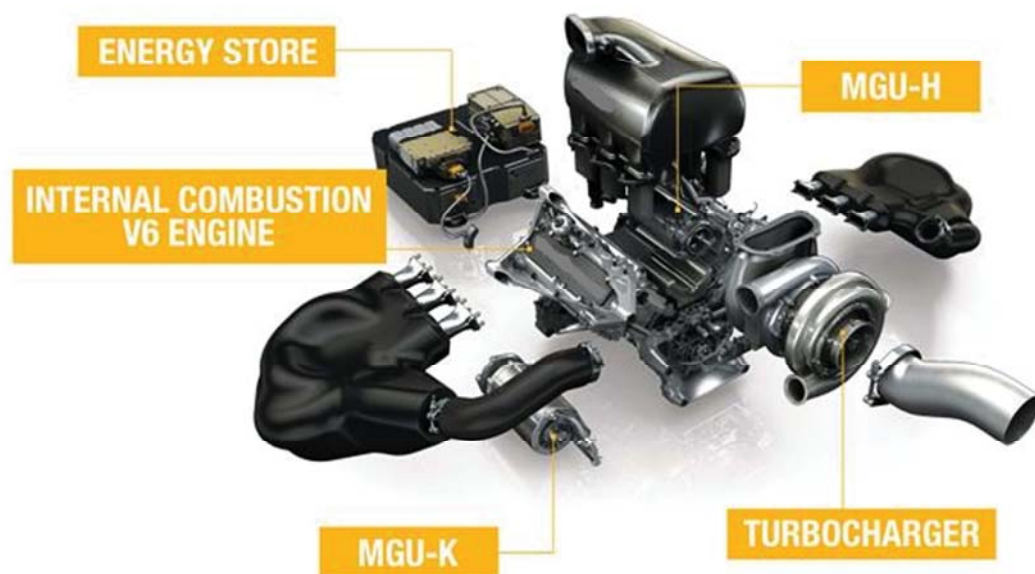
FIGURE 1.31 – Structure du moteur à combustion interne
