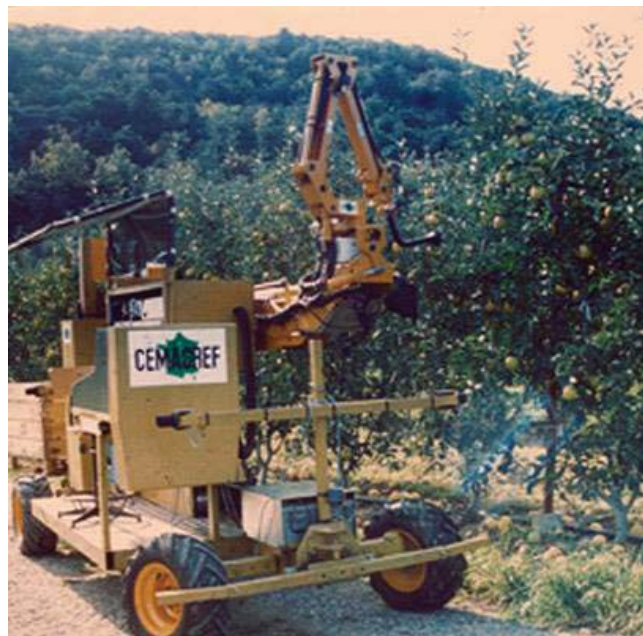
FIGURE 0.1 – Robot Magali sur sa structure porteuse et en action
