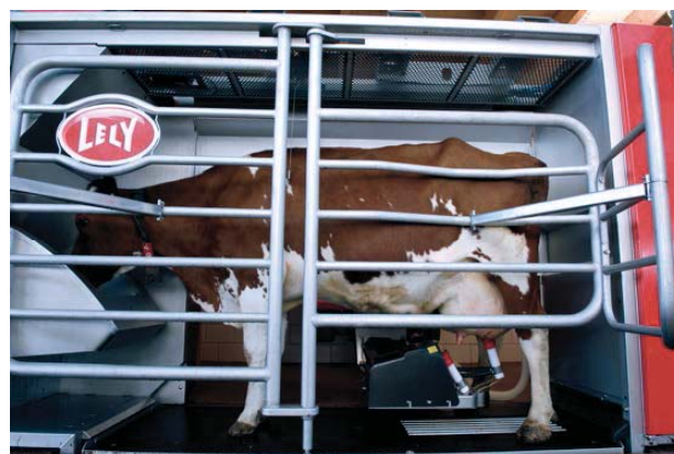
FIGURE 1.2 – Vache en phase de traite et d'alimentation dans le box du robot de traite LELY Astronaut A3 (d'après plaquette LELY)
