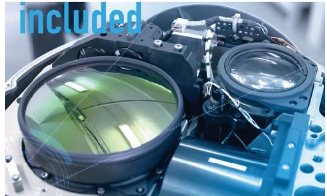
Figure 14 – Intérieur du FLIR, vue des optiques des caméras liées à l'étage fin d'élévation
