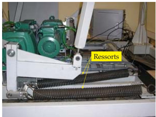
FIGURE 7 – Système de compensation par ressorts
