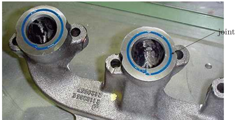
Figure 2 – Collecteur avec son joint d'étanchéité
