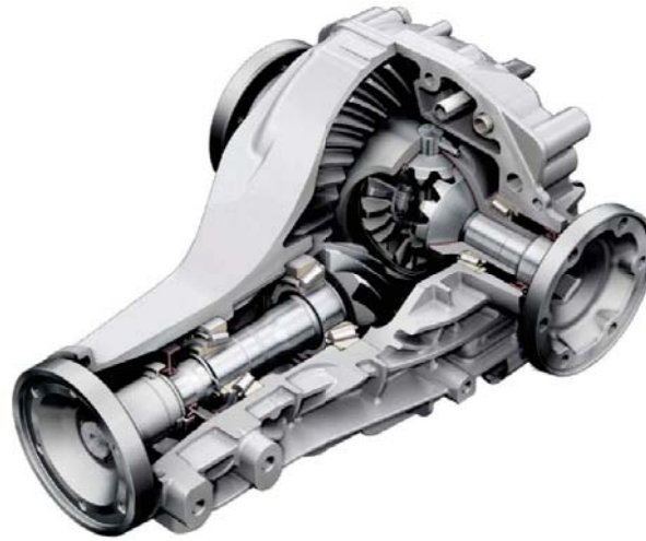
Figure 8 – Modélisation 3D d'un différentiel
