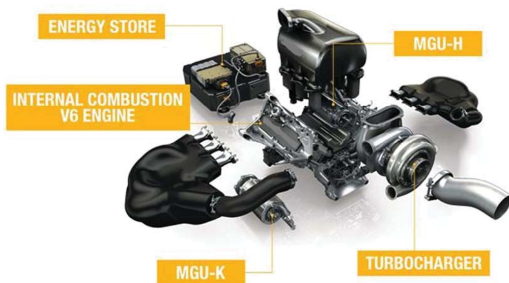
FIGURE 1.31 – Structure du moteur à combustion interne
